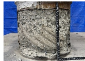
(a) モーメント-変形角関係(変動軸力-0.5~0.5) (b) 終了後のコンクリート損傷状況
