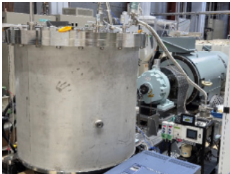
図1: 130 kW級高温超伝導液体水素ポンプのヘリウムガス冷却回転試験ベンチの外観(受託2)
