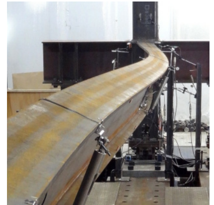
H形断面梁の横座屈
