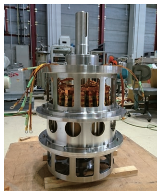
図: 世界初の変速負荷試験に成功した 50kW級高温超伝導誘導同期モータ (JST-ALCAプロジェクト)
