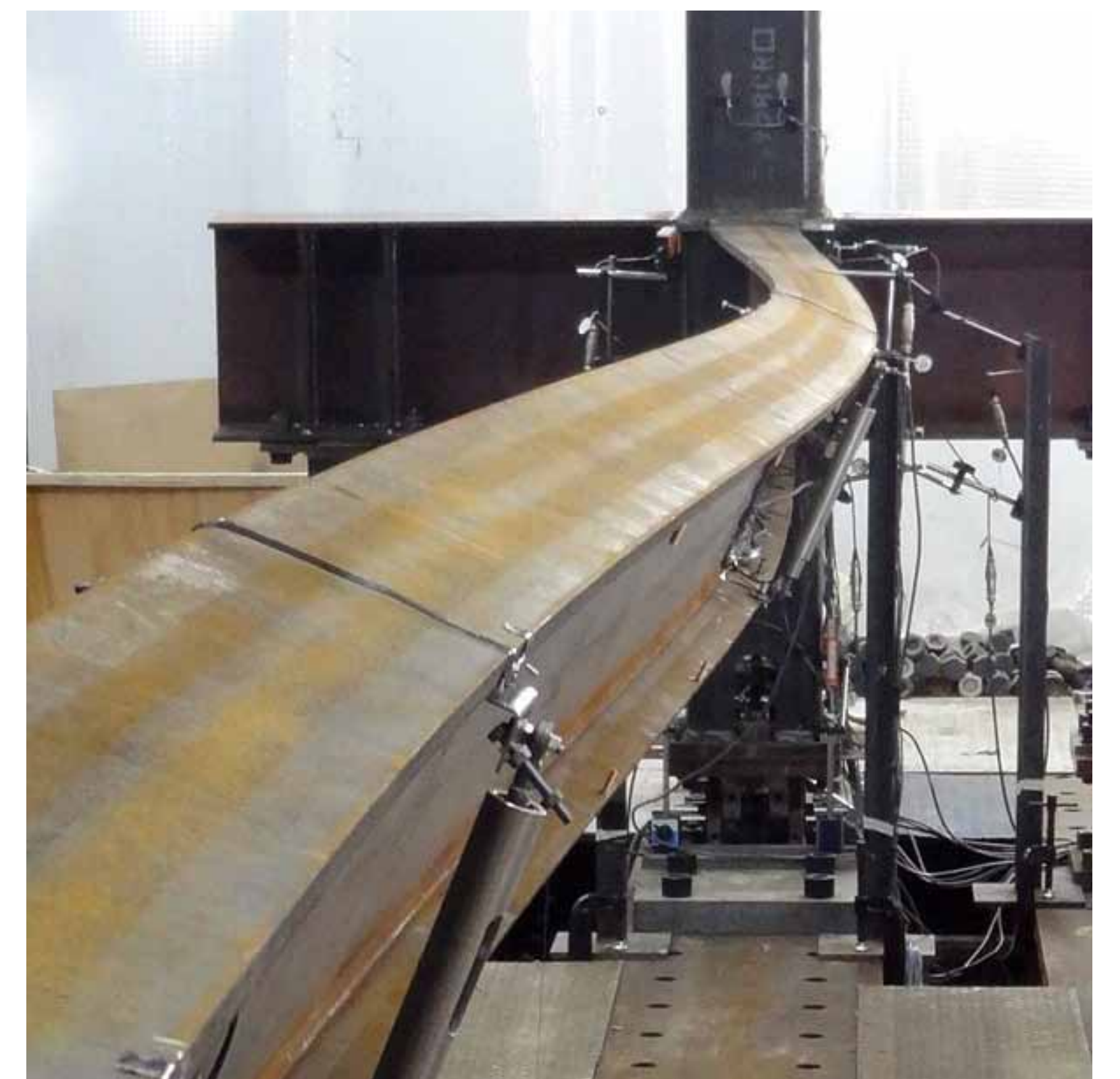
H形断面梁の横座屈
