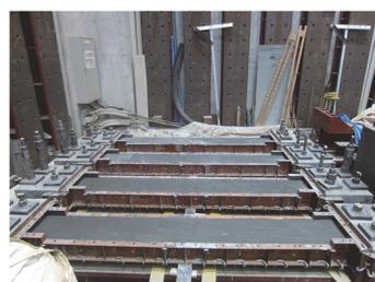
11. 乾燥収縮試験部分: 打設完了
