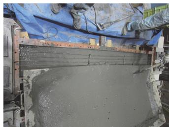
10. 乾燥収縮試験部分: 打設状況
