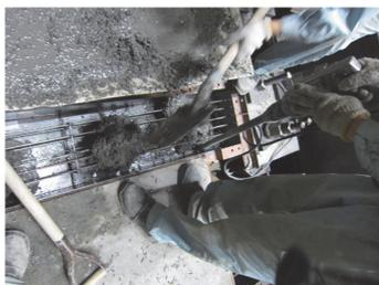
9. 乾燥収縮試験部分: 打設状況
