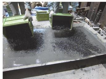
7. 乾燥収縮試験部分: 材料調合
