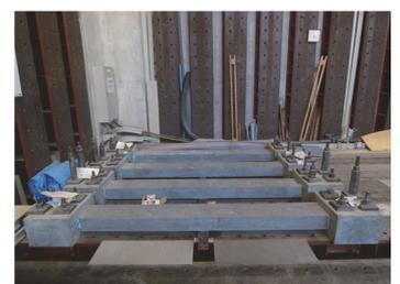
12. 乾燥収縮試験部分: 脱型状況
