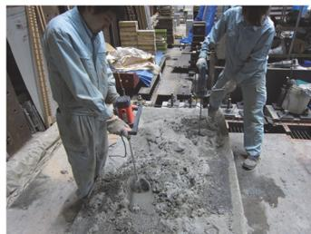
6. 乾燥収縮試験部分: 材料投入
